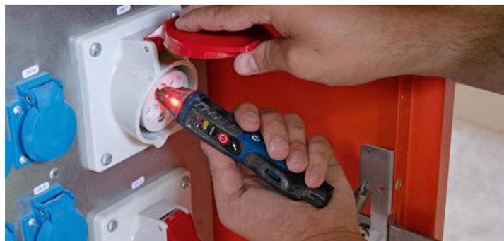
Le GVD 1000-17 Professional convient aux chantiers exigeants grâce à son indice de protection IP67 contre la poussière et les projections d'eau et son boîtier robuste et caoutchouté qui le protège contre les chutes jusqu'à 2 m de hauteur.
