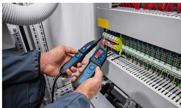
Sur chaque poignée de l'outil, un bouton permet de tester un RCD et déclencher des dispositifs de protection de courant résiduel (commutateur RCD / FI).
