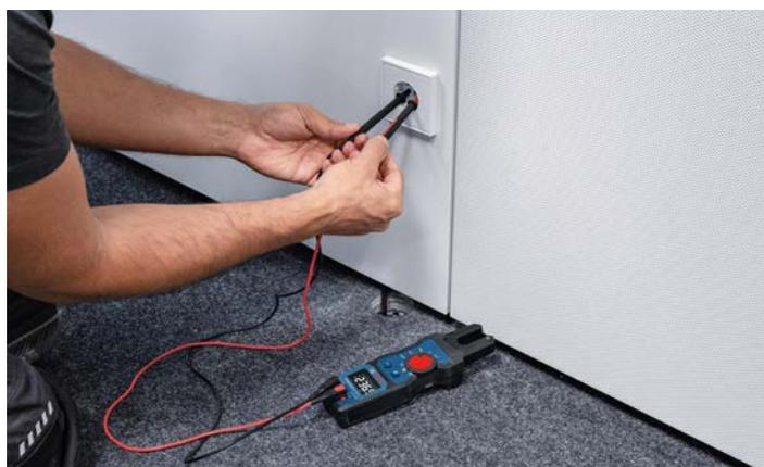
Grâce à la conception à fourche, les utilisateurs peuvent mesurer du courant jusqu'à 200 A CA sans cordons de mesure, ce qui leur offre un gain de temps. **Son ouverture de mâchoire de 16 mm permet une mesure non invasive du courant alternatif.** Le travail dans des zones étroites est plus rapide et ne nécessite pas de couper les circuits.
